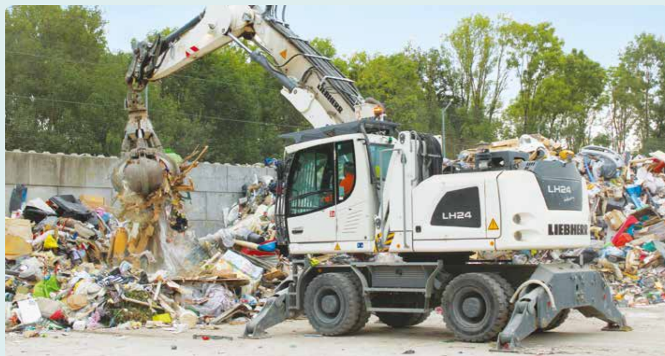
Tri au sol du tout-venant dans le centre de transfert de Rambouillet (Yvelines) pour en extraire la fraction incinérable.
